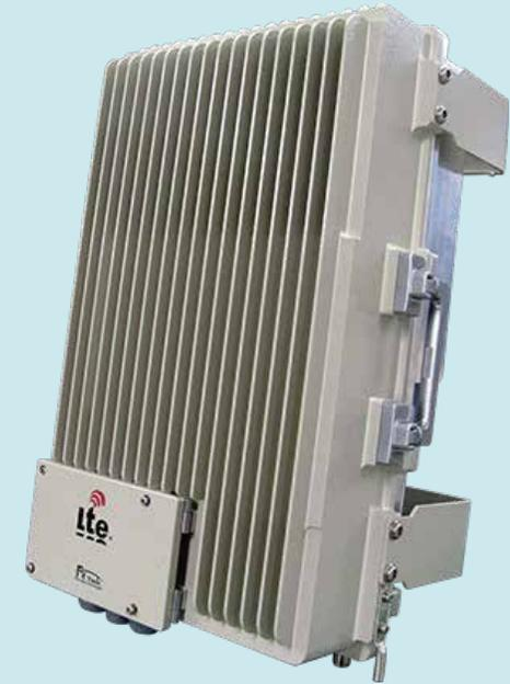
RRH란 기지국의 제어부로부터 무선부(RF)를 분리한 제품으로서, 기존의 기지국에 비하여 대폭적으로 무선부(RF)를 소형, 경량화하여 옥내 및 옥외의 다양한 환경하에서 간편한 설치와 유연한 이동통신서비스 운영을 가능하도록 하는 장비입니다. 에프알텍은 삼성전자와 협력하여 고품질의 RRH를 삼성전자에 생산공급하고 있으며, 자체개발한 고효율 앰프를 적용한 RRH를 개발하여 테스트 중에 있습니다.
