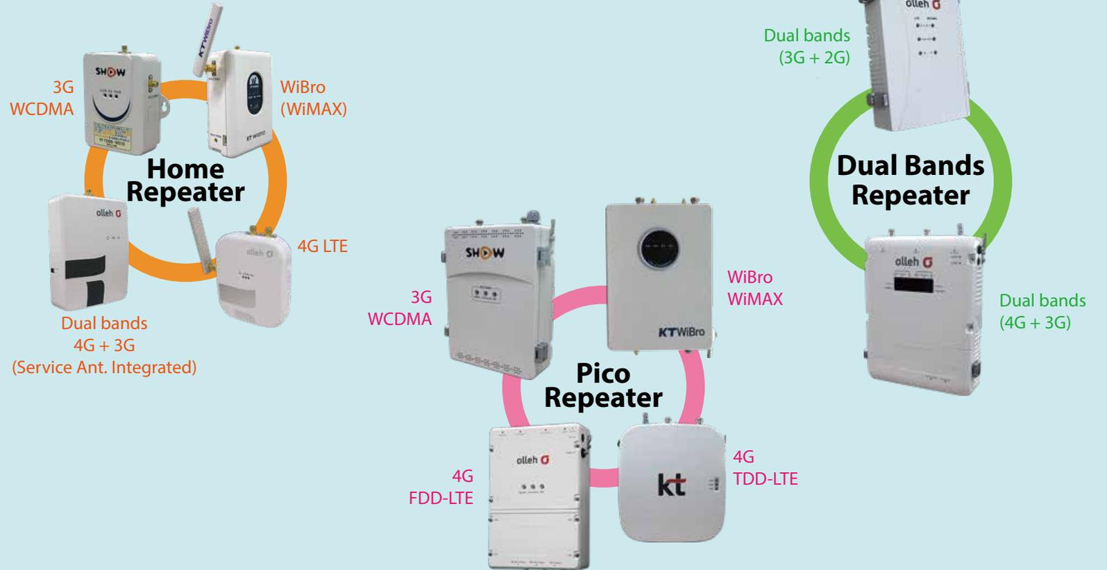
기지국의 서비스 신호를 링크 안테나를 통해 무선으로 수신하여 일정출력으로 증폭한 후 서비스 안테나를 통해 주로 건물내 서비스 신호 품질을 개선하는 데 사용되는 장비로서 가장 일반적으로 사용되는 중계기입니다. 에프알텍은 다양한 형태의 건물내 서비스 품질 개선을 위해 7dBm 출력의 담배갑만한 크기의 닥내형 중계기에서 초소형, 소형, 중형 및 10W급의 고출력 장비까지 그리고 하나의 장비로 2G와 3G 또는 3G와 LTE서비스를 동시에 할 수 있는 듀얼밴드 중계기 등 수십종류의 모델을 개발하여 생산공급하고 있습니다.
