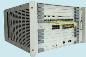
인빌딩 CCC 솔루션은 멀티섹터 지원이 가능한 DAS 시스템으로 가입자가 특정시간에 많이 몰리는 대형건물내에서도 유연한 섹터운영이 가능합니다. 이를 통해 특정 섹터에 가입자가 몰릴 경우 자동으로 섹터를 변환하여 섹터간 트래픽 밸런싱이 자동으로 가능하도록 설계하였습니다.
